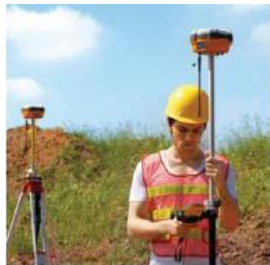
Планово-высотная привязка аэрофотоснимков
