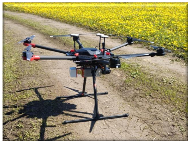
БПЛА DJI Matrice M600 с лазерным сканером RIEGL miniVUX
